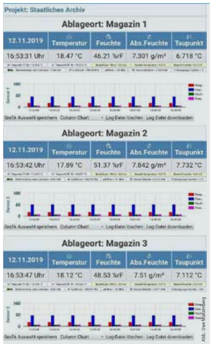
Abb. 3: Beispiel für eine Onlineabfrage von Raumklimadaten im Browser mit einer Überwachungs- und Steuerungssoftware („Liwogate“)
