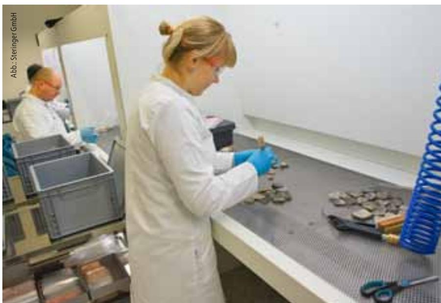
Abb. 5: Durch eine höhere Abluftleistung und Luftführung ist es möglich, die Dekontaminationsarbeiten in den Sicherheitswerkbanken ohne Atemschutz durchzuführen.
