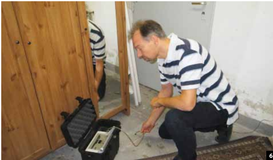
Abb. 6: Während der Unterdrucksituation werden Radon-Eintrittspfade aktiviert und können leichter mit dem Radon-Sniffing gefunden werden.
